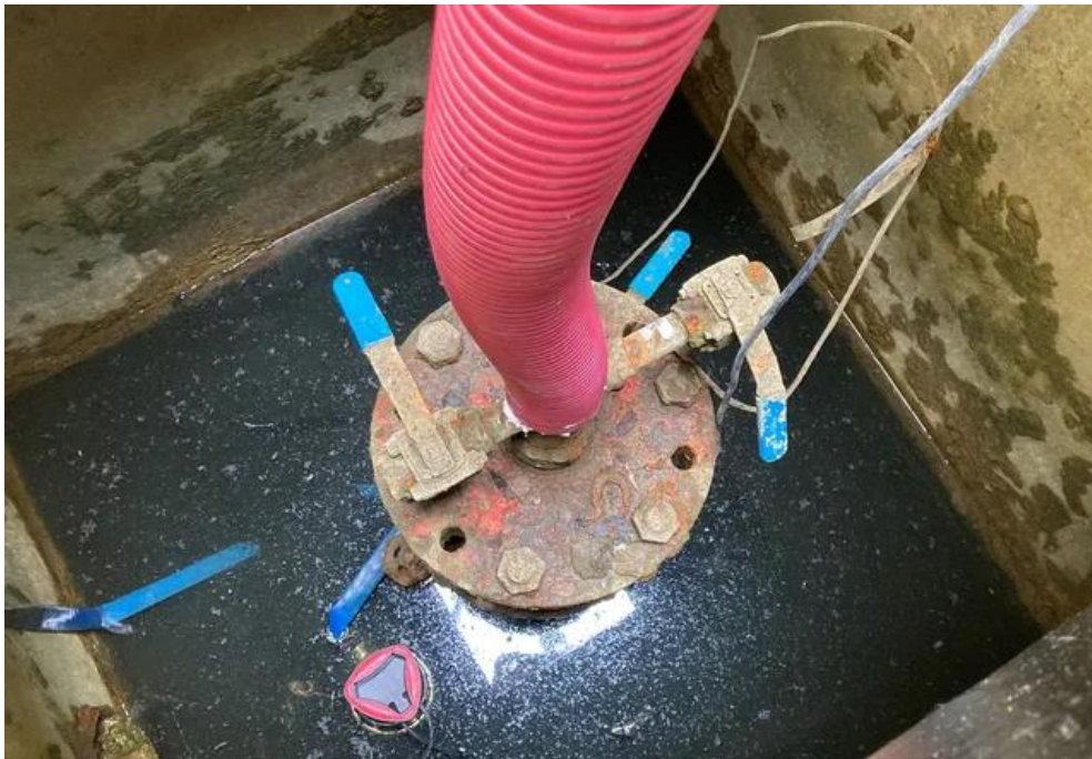
Figure 4. Sonde conçue au laboratoire GéoRessources utilisée sur le site pilote de Folschviller. (Permet d'analyser les gaz à plus de 1000 mètres de profondeur).
