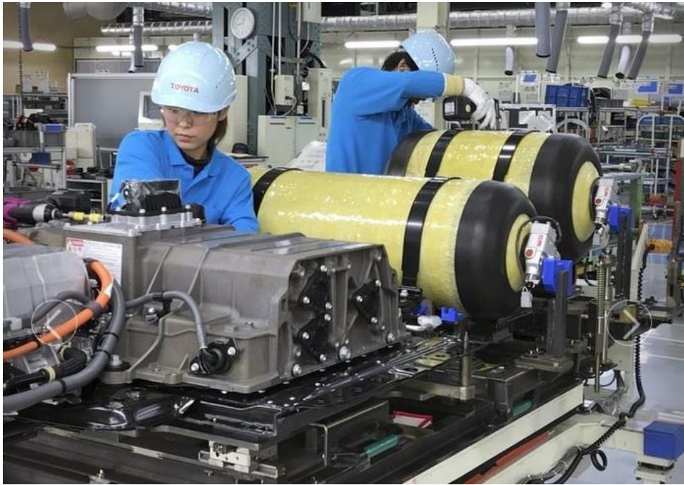
Figure 14 - La chaîne de montage de la Mirai (au premier plan, le stack et, derrière, les deux réservoirs d'hydrogène)
