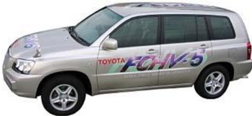
Figure 3 - Le prototype FCHV-5, à reformeur essence (2001)
